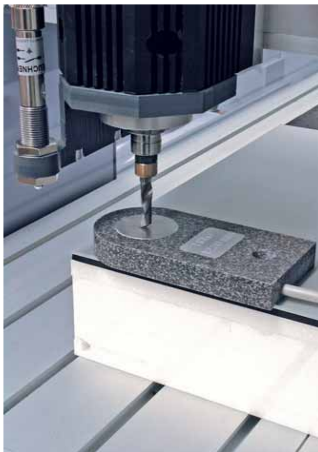
Misurazione della superficie del pezzo nell'arco di pochi secondi con il dispositivo mobile di regolazione.
