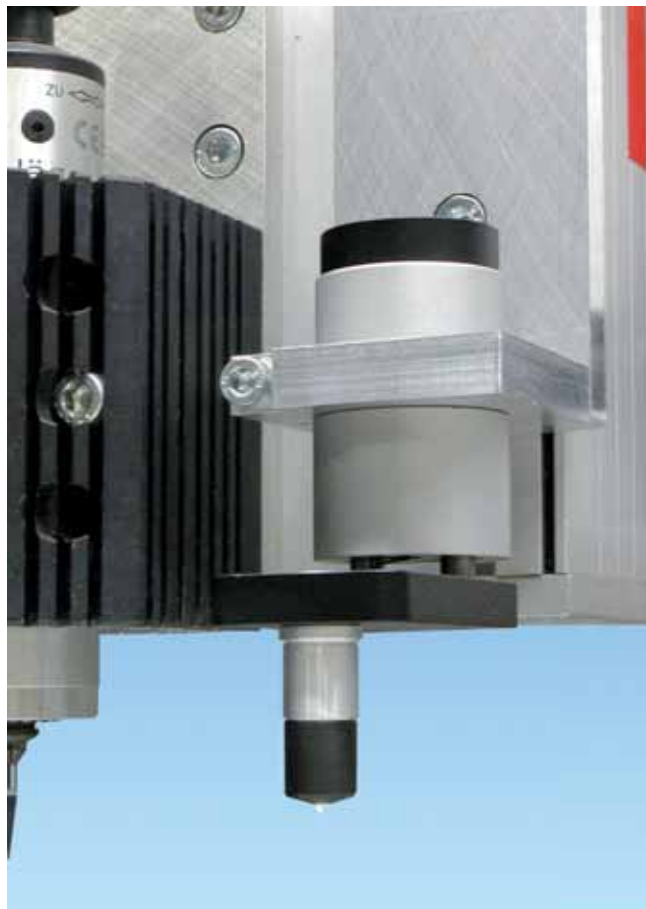
Unità lama di trascinamento con supporto elastico, qui montata a destra del mandrino.
