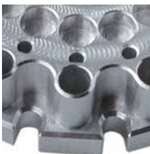
Fresatura di tasche a diversi livelli di altezza.
