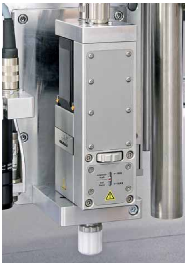
Testa di taglio tangenziale con unità di taglio con supporto a molla per pellicole e materiale floccato.
