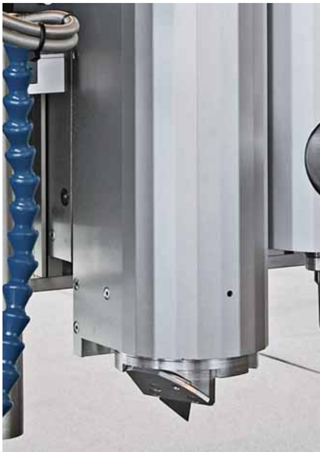
La testa universale è indicata per molte applicazioni – in questa illustrazione è dotata di una lama V-Cut per taglio in diagonale a 45°.
